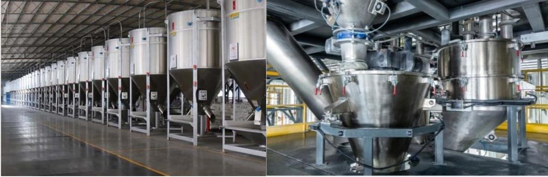
图 3 物料储料仓定量及密闭投料系统
