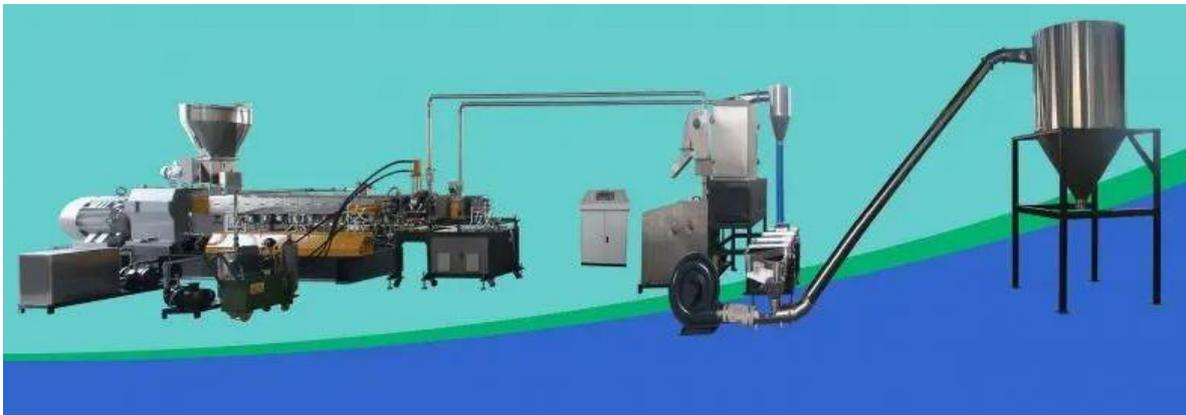
图 4 典型双螺杆挤出-水下拉条切粒线的设备
