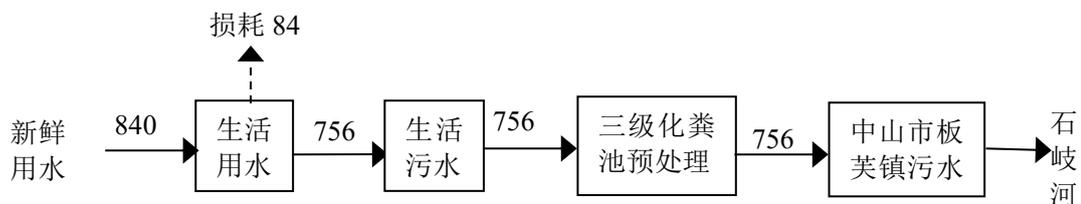
图 1 项目水平衡图 (t/a)
