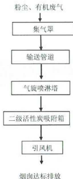
废气处理系统工艺简图
