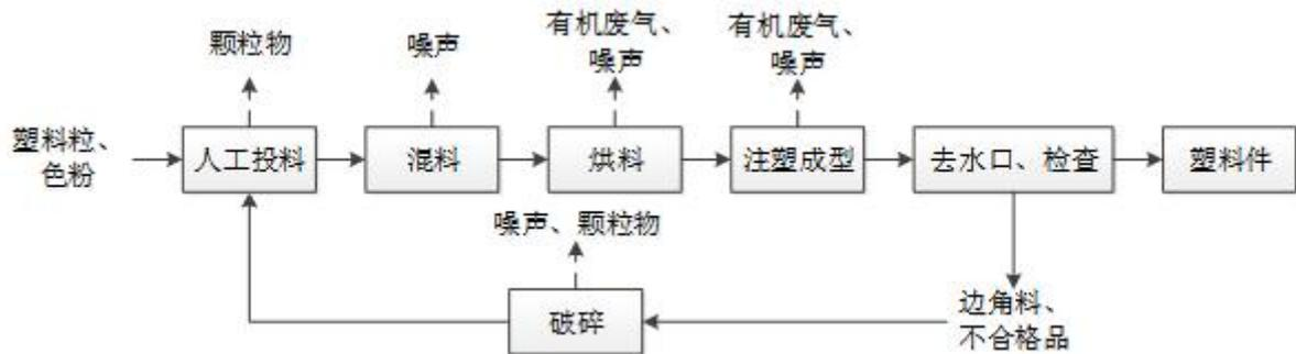
图2-1 项目生产工艺流程图
