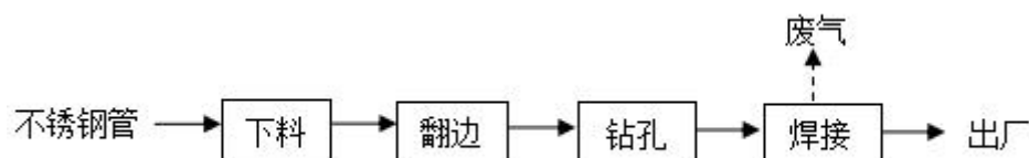
图3 不锈钢分配器组件工艺流程图
