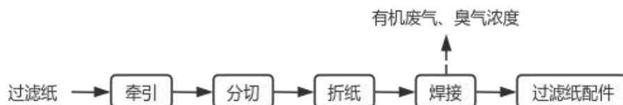
图 3 过滤纸配件生产工艺流程图
