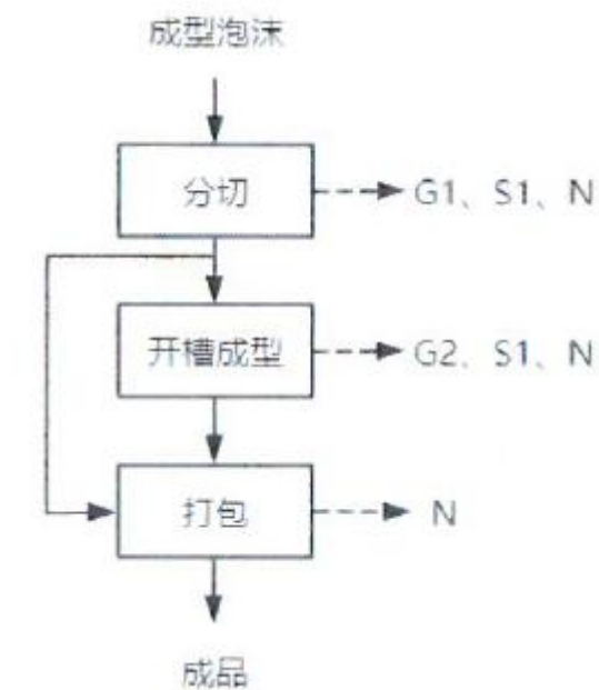
图2-1 泡沫包装制品生产工艺流程图
