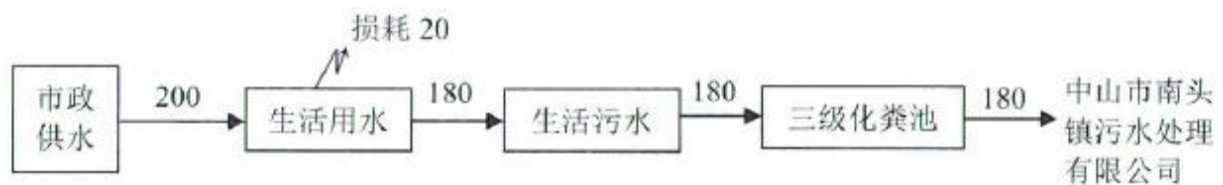
图 1 项目实际水平衡图（单位：t/a）
