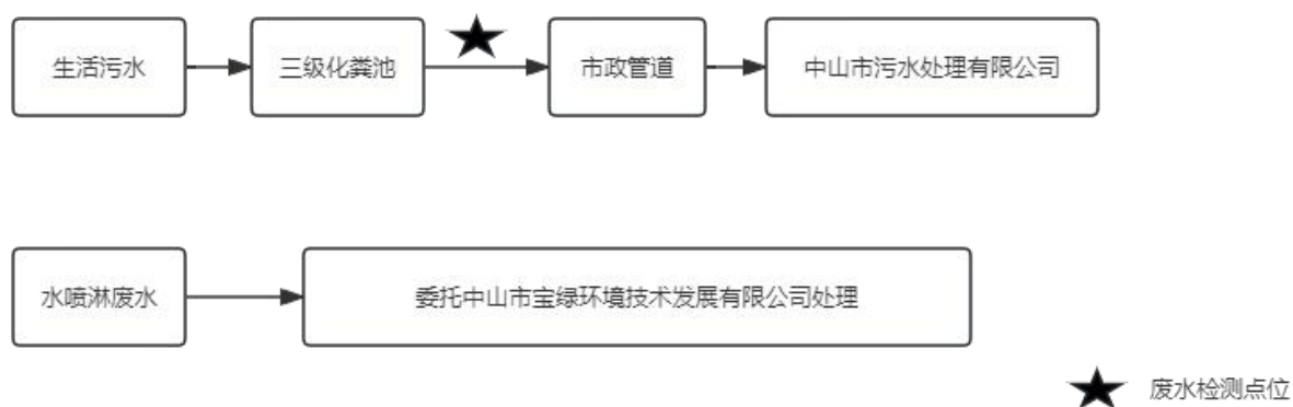
图 3-1 废水处理工艺流程图
